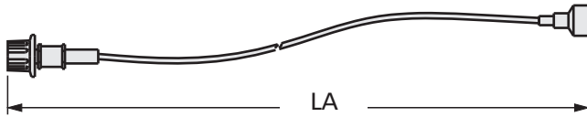
Die Standardlänge des Fernbedienkabels ist 1220 mm. Weiter Längen sind auf Anfrage erhältlich.
