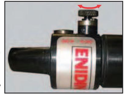
Einstellung 0 für minimale Dämpfung, Einstellung 8 für maximale Dämpfungskraft. 180° Einstellung mit Arretierung.
